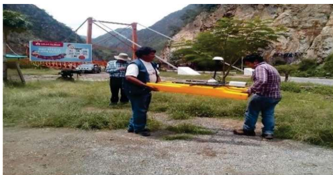
Figura 9. Aforo con Q-Liner en la Estación hidrométrica del puente Kunyayq.
