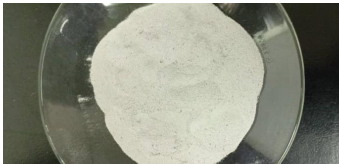
Fig. 1. Muestras del Material de Referencia Interno de baño electrolítico (MRI002) [14].
