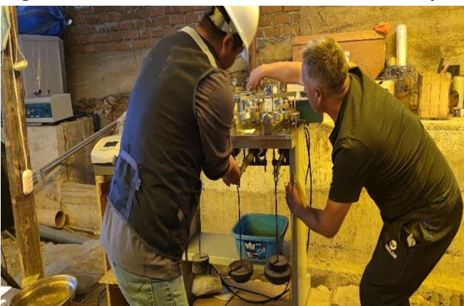
Fig. 2. Realización del ensayo de CBR
