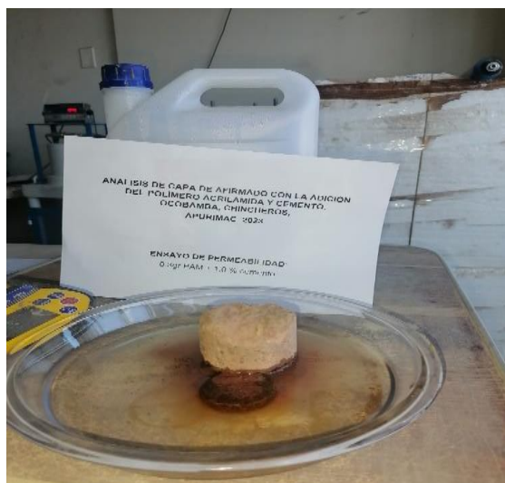
Fig. 3. Realización del ensayo permeabilidad
