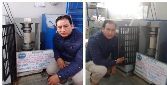
Fig. 01. Imágenes que muestra la rotura de briquetas con prensa a 1.20 kN/s
