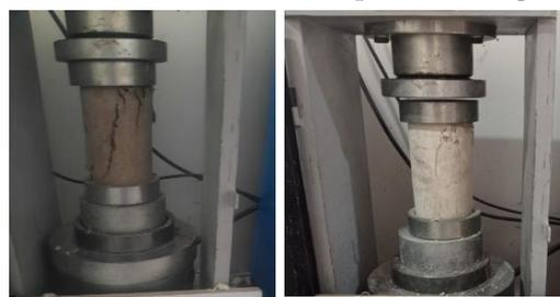
Fig. 02. Imágenes que muestra la fisuración - tipo de falla en la briqueleta que se sometió a esfuerzo de compresión.
