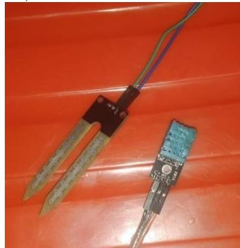
Fig. 3: sensores de humedad y temperatura
